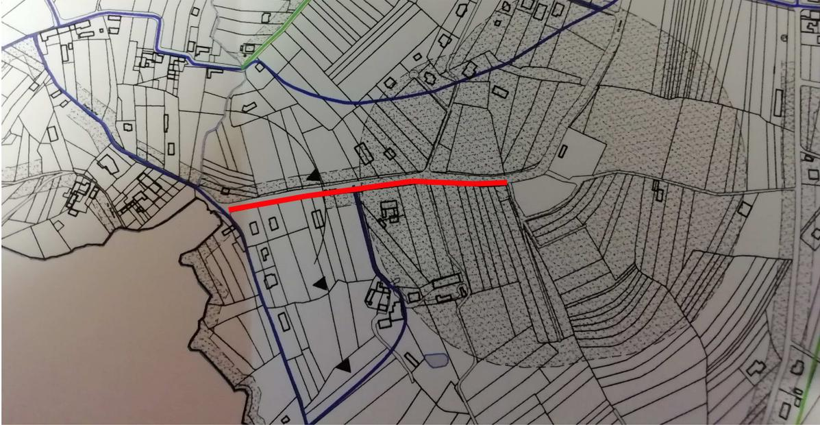
*Figura 7: Stralcio non in scala della Carta Urbanizzazioni primarie del PRGC di Frossasco con ubicazione delle condotte della fognatura esistente (linee blu) e del sito di progetto (linea rossa)*
