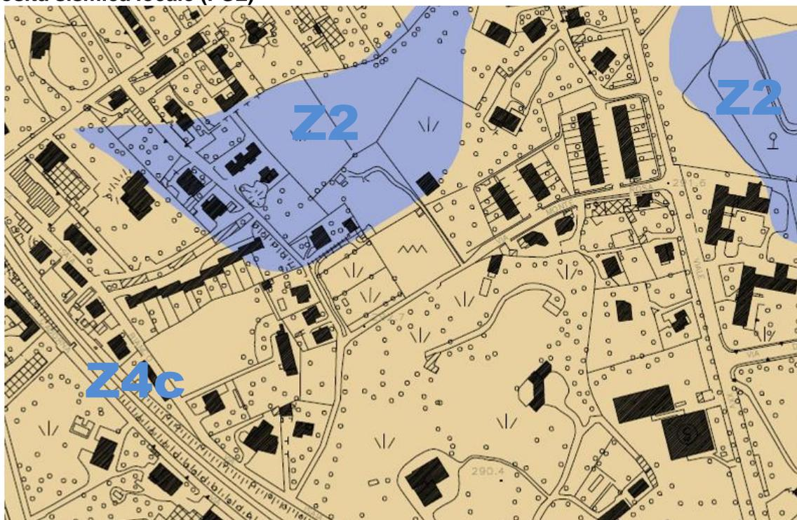
**Scenario pericolosità sismica locale – Z4c:** zona di pertinenza dei depositi morenici e delle relative morfologie (cordoni); questa classe rappresenta le aree subpianeggianti o a bassa acclività corrispondenti ai terrazzi delle colline moreniche con presenza di depositi granulari e/o coesivi e di coltri loessiche di spessori variabili. Tale scenario corrisponde alle unità litologiche “morenico debolmente alterato” e “morenico profondamente alterato”
