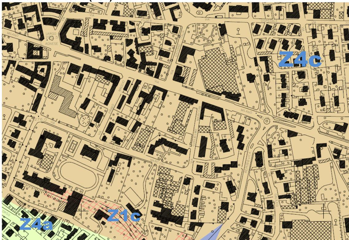
**Scenario pericolosità sismica locale – Z4c:** zona di pertinenza dei depositi morenici e delle relative morfologie (cordoni); questa classe rappresenta le aree subpianeggianti o a bassa acclività corrispondenti ai terrazzi delle colline moreniche con presenza di depositi granulari e/o coesivi e di coltri loessiche di spessori variabili. Tale scenario corrisponde alle unità litologiche “morenico debolmente alterato” e “morenico profondamente alterato”
