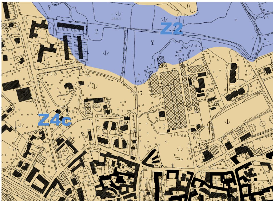
**Scenario pericolosità sismica locale – Z2:** Zone con terreni di fondazione scadenti. Depositi recenti di riempimento dei paleovalvei di scaricatori caratterizzati con sedimenti da sciolti a poco addensati di spessore ridotto (da 0 a pochi metri).
