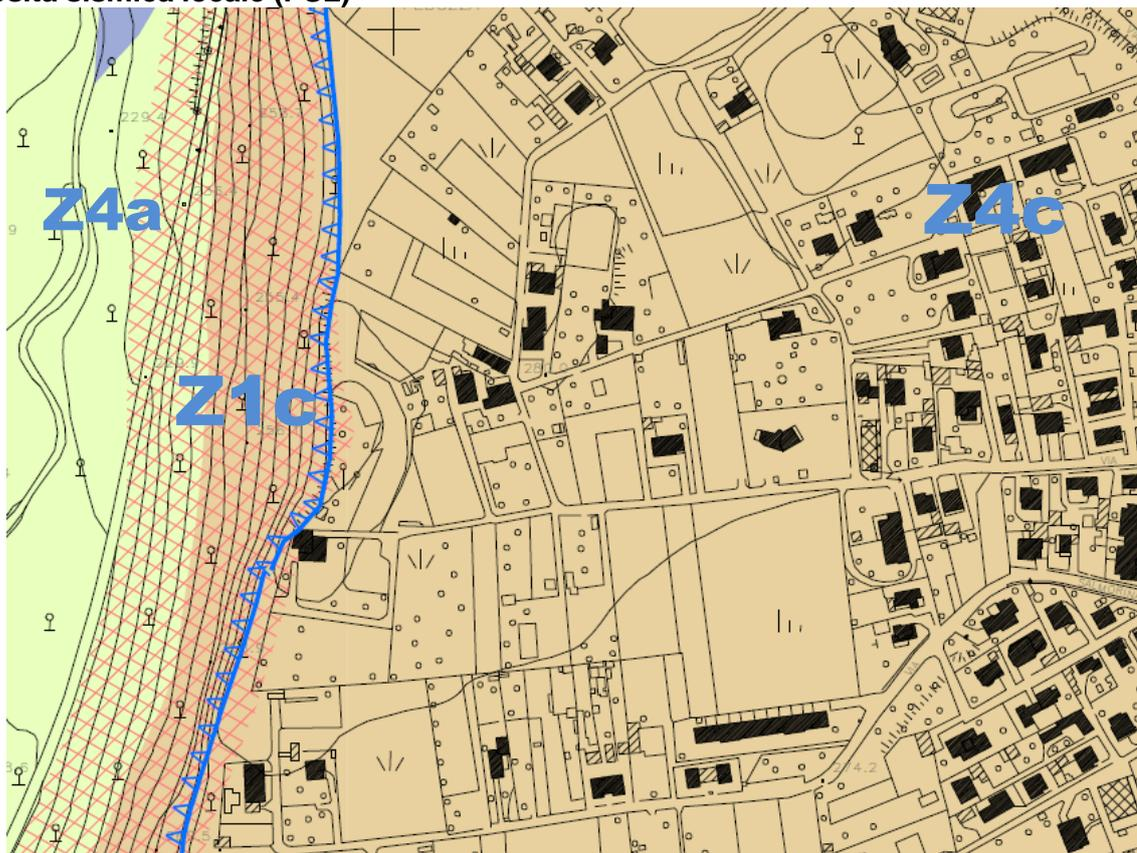
**Scenario pericolosità sismica locale – Z4c:** zona di pertinenza dei depositi morenici e delle relative morfologie (cordoni); questa classe rappresenta le aree subpianeggianti o a bassa acclività corrispondenti ai terrazzi delle colline moreniche con presenza di depositi granulari e/o coesivi e di coltri loessiche di spessori variabili. Tale scenario corrisponde alle unità litologiche “morenico debolmente alterato” e “morenico profondamente alterato”
