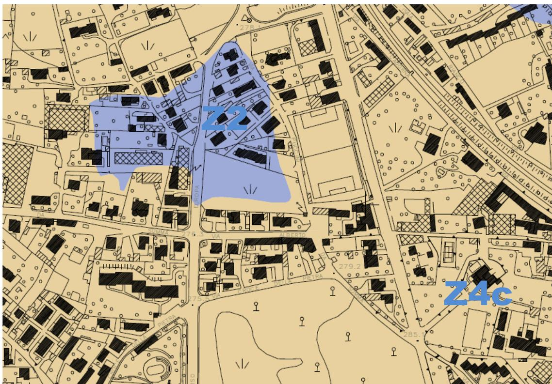
**Scenario pericolosità sismica locale – Z2:** Zone con terreni di fondazione scadenti. Depositi recenti di riempimento dei paleovalvei di scaricatori caratterizzati con sedimenti da sciolti a poco addensati di spessore ridotto (da 0 a pochi metri).
