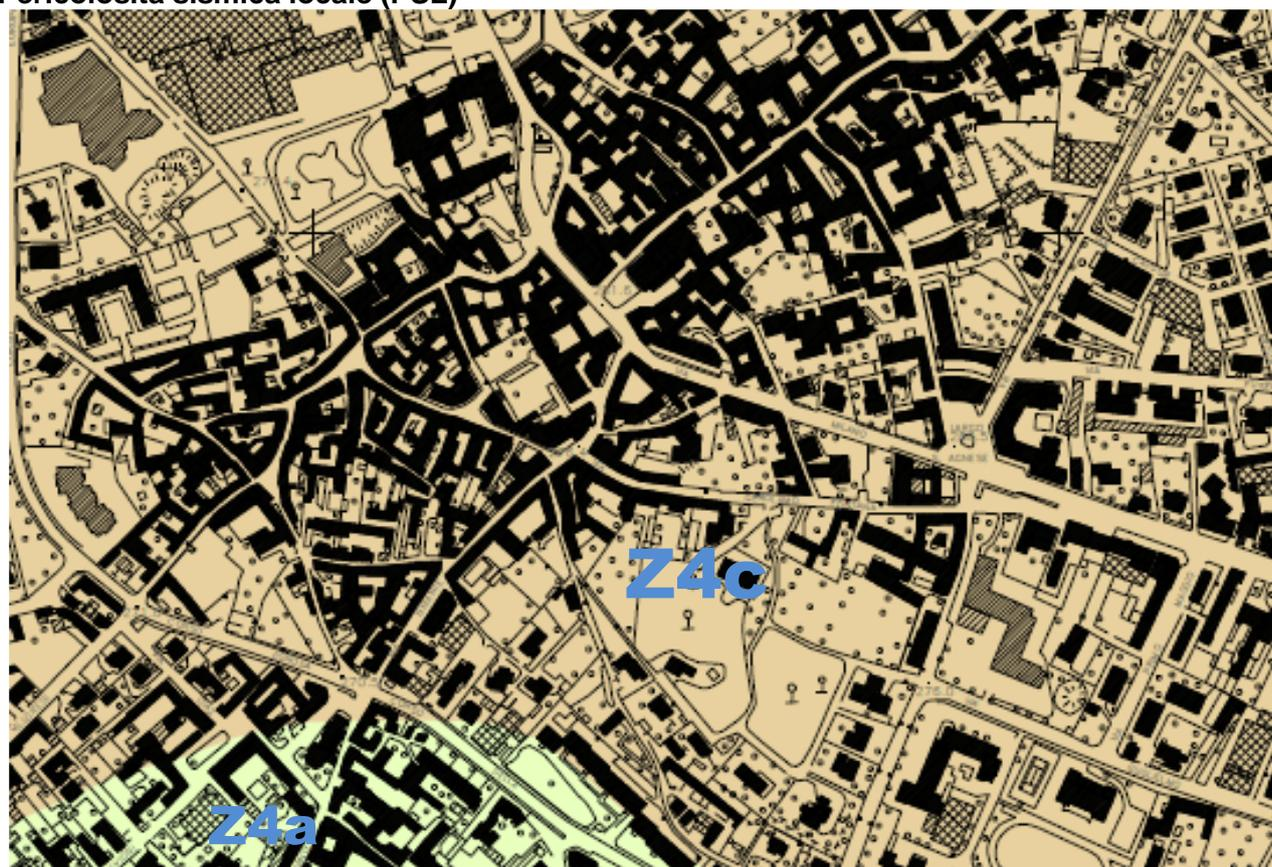
**Scenario pericolosità sismica locale – Z4c:** zona di pertinenza dei depositi morenici e delle relative morfologie (cordoni); questa classe rappresenta le aree subpianeggianti o a bassa acclività corrispondenti ai terrazzi delle colline moreniche con presenza di depositi granulari e/o coesivi e di coltri loessiche di spessori variabili. Tale scenario corrisponde alle unità litologiche “morenico debolmente alterato” e “morenico profondamente alterato”
