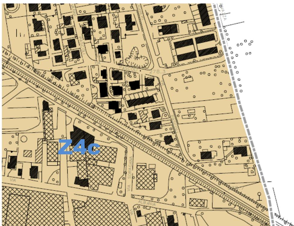
**Scenario pericolosità sismica locale – Z4c:** zona di pertinenza dei depositi morenici e delle relative morfologie (cordoni); questa classe rappresenta le aree subpianeggianti o a bassa acclività corrispondenti ai terrazzi delle colline moreniche con presenza di depositi granulari e/o coesivi e di coltri loessiche di spessori variabili. Tale scenario corrisponde alle unità litologiche “morenico debolmente alterato” e “morenico profondamente alterato”
