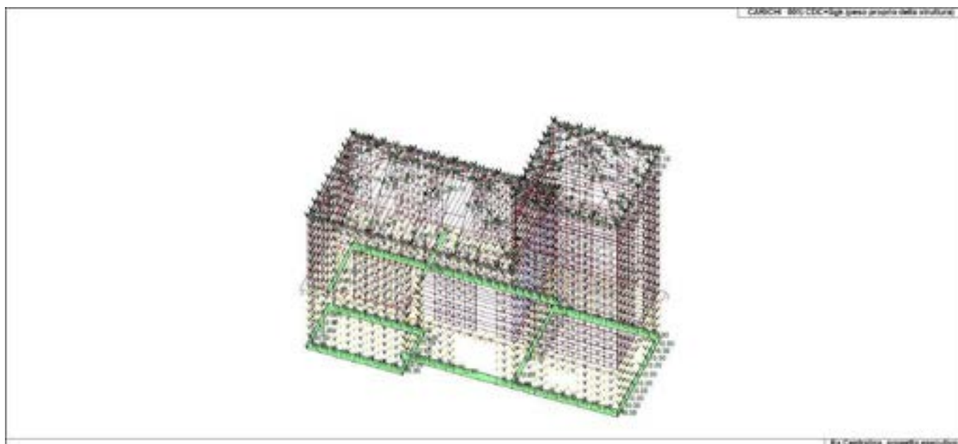
22_CDC_001_CDCCGk peso proprio della struttura
