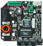
Switch ethernet industriale sviluppato da Selea per essere inserito all'interno della telecamera, provvisto di 3 porte LAN di cui una con uscita P.O.E. 802.3af per alimentare qualsiasi tipo di telecamere IP esterna o qualsiasi dispositivo Wireless Wi-Fi o Gprs/Umts utilizzando un solo cavo di rete.
