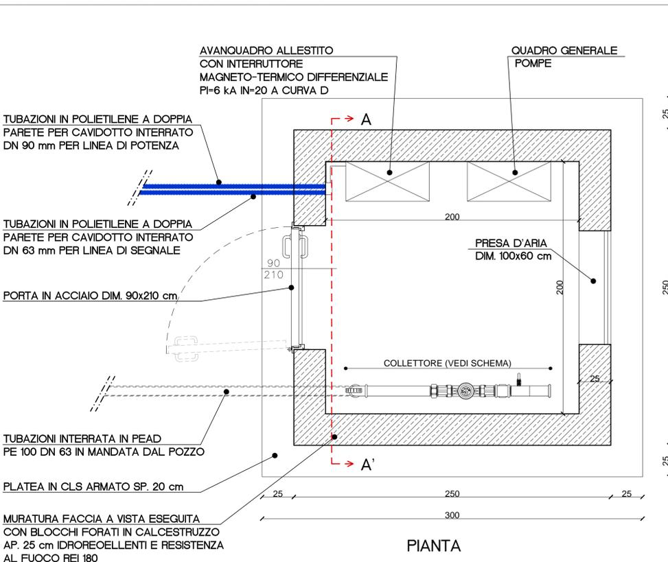
SEZIONE E PARTICOLARI COSTRUTTIVI POZZO - SCALA 1:20
