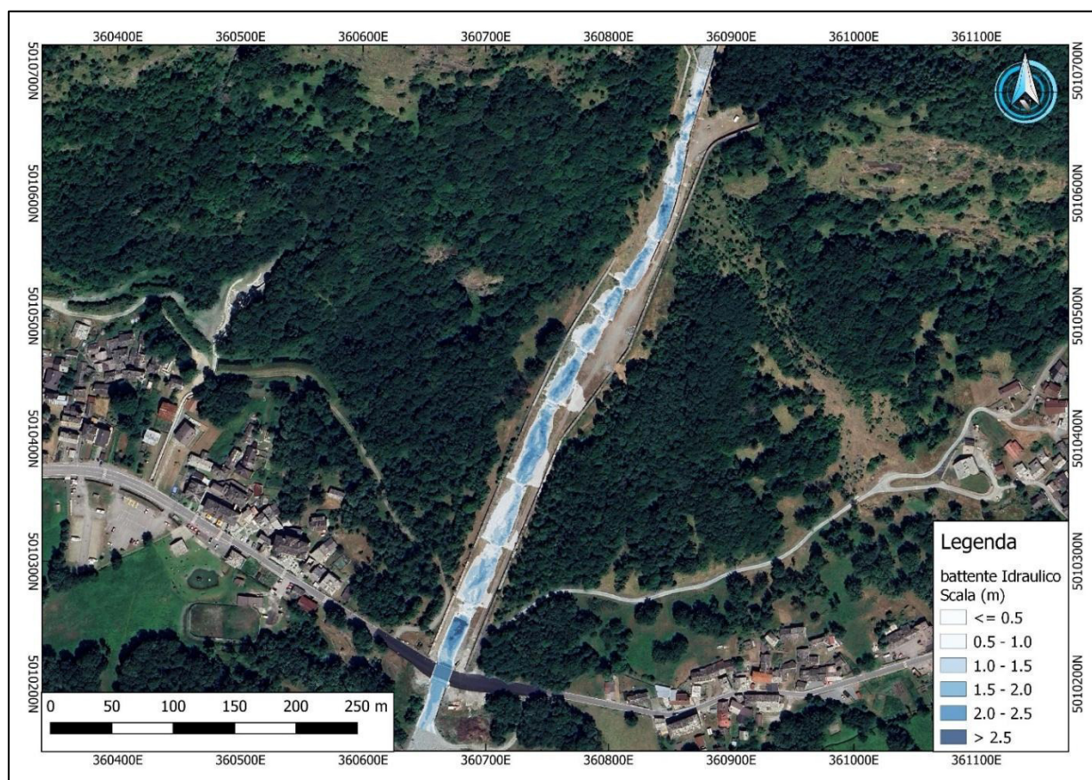
Figura 5 - Battente idraulico per una portata con tempo di ritorno di 200 anni riferito allo stato attuale.
