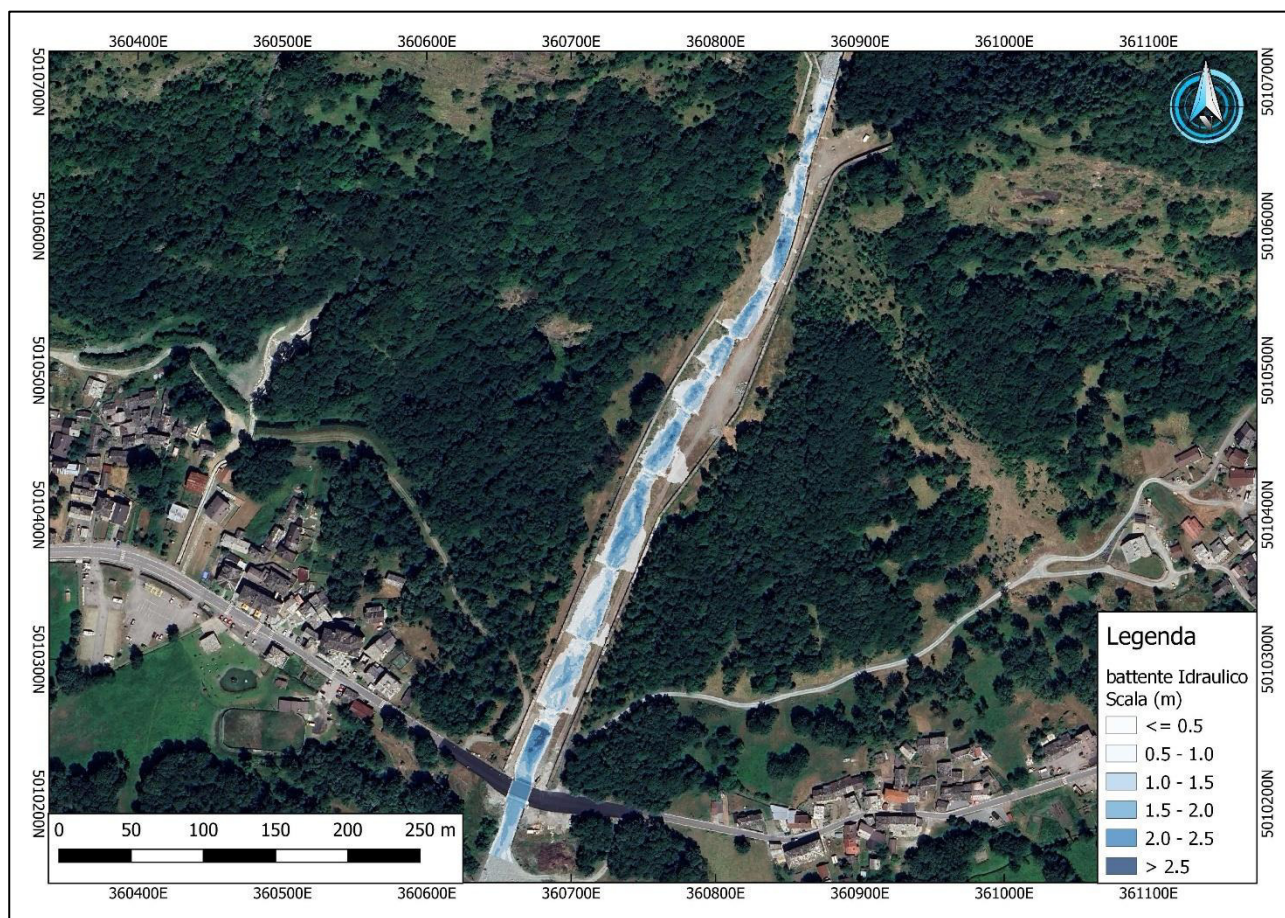
Figura 3 - Battente idraulico per una portata con tempo di ritorno di 200 anni riferito allo stato attuale.
