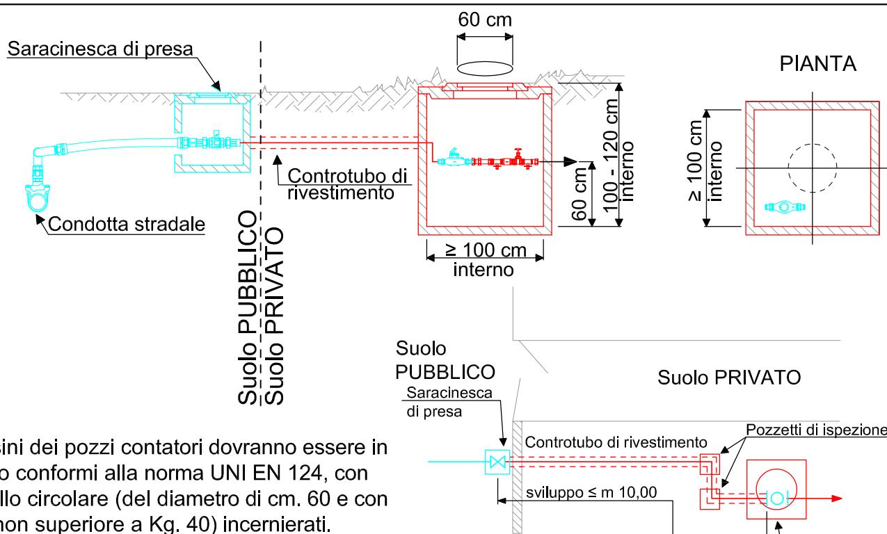
I chiusini dei pozzi contatori dovranno essere in metallo conformi alla norma UNI EN 124, con suggello circolare (del diametro di cm. 60 e con peso non superiore a Kg. 40) incernierati.
