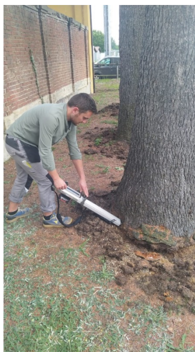
Fig.3 Esempio di scheda albero fornita dallo studio e analisi del legno con resistografo
