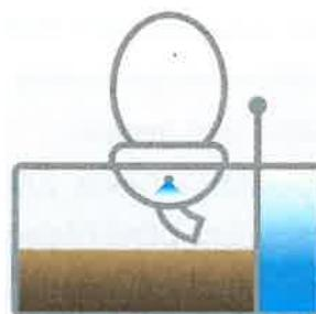
In particolar modo i bagni Sebach rientrano nella categoria prevista dalla suddetta norma dei "**bagni a serbatoio con vaso sanitario con sistema di scarico a flusso di acqua fresca ad attivazione a mano o a pedale** (Tipo3 "AD ACQUA PULITA"), così come evidenziato nello schema sottostante.
